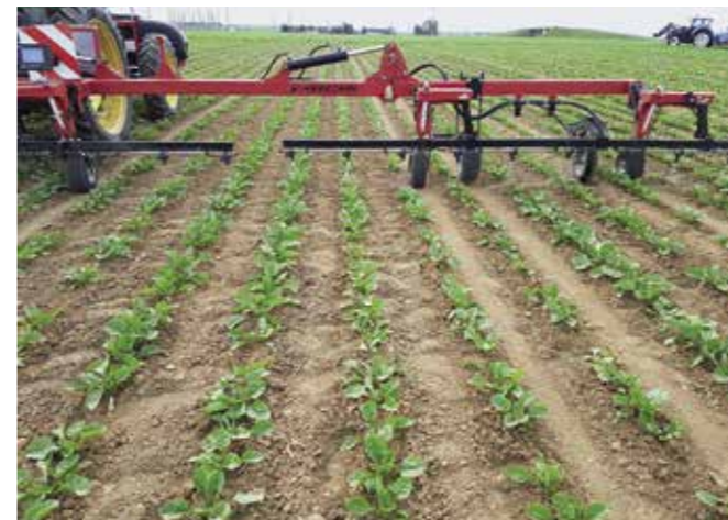
Im REB-Programm M2 ist Bandspritzen ab der Saat vorgeschrieben. Hacken zwischen den Reihen.
